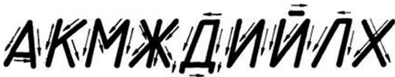
Рис. 5. Начертание прописных букв, состоящих из горизонтальных, вертикальных и наклонных элементов.
