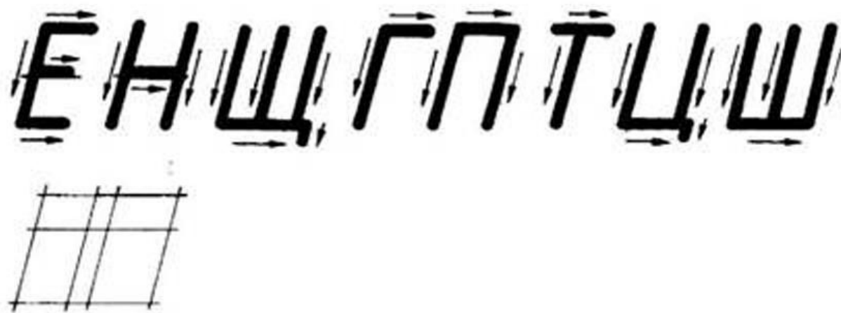
Рис. 4. Начертание прописных букв, состоящих из горизонтальных и вертикальных элементов, и построение вспомогательной сетки.
