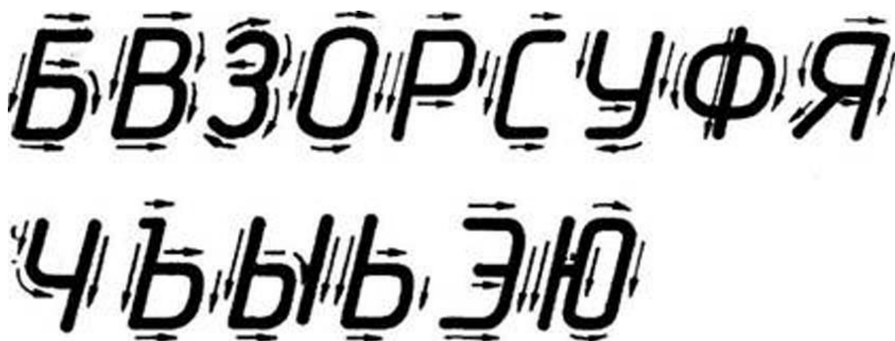
Рис. 6. Начертание прописных букв, состоящих из прямолинейных и криволинейных элементов.
